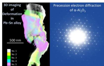
▶ 左図:その場変形電子線トモグラフィー
