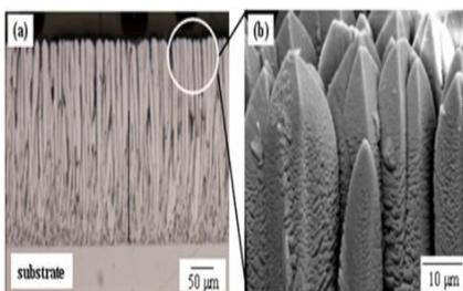
電子ビーム蒸着法によるZrO<sub>2</sub>コーティング
