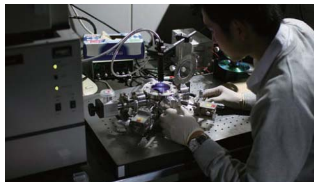
光電変換素子の分光感度測定の様子
