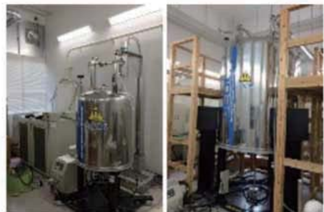
図2. 石炭灰分析用多核固体NMR
