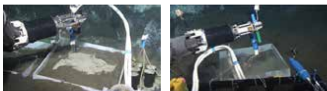
図1 海底被覆材の実地実験結果 (左：難拡散性を有した被覆材、右：拡散した被覆材)
