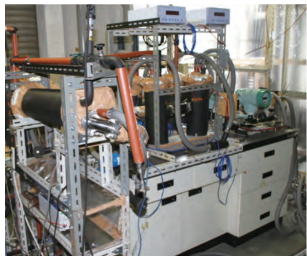
図1. 活性炭とエタノールを利用した吸着式冷凍機の実験機
