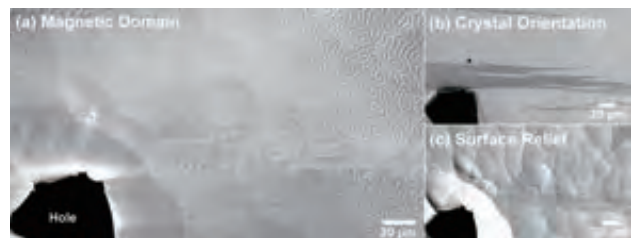
図2. 異なる電子検出器で取得したCo-Pt強磁性合金の (a) 迷路状磁区構造を示すSEM像 (b) 結晶方位の違いを示すSEM像 (c) 表面形状を示すSEM像
